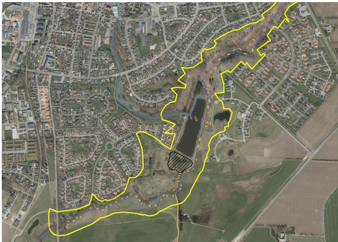
Figur 6-3 Projektstrækning mellem st. 3.440 – 5.750 med eksisterende forløb (blå streg), slyng (rød streg), stryg (gul streg) og udvidelse af regnvandsbassin (sort skravering).
